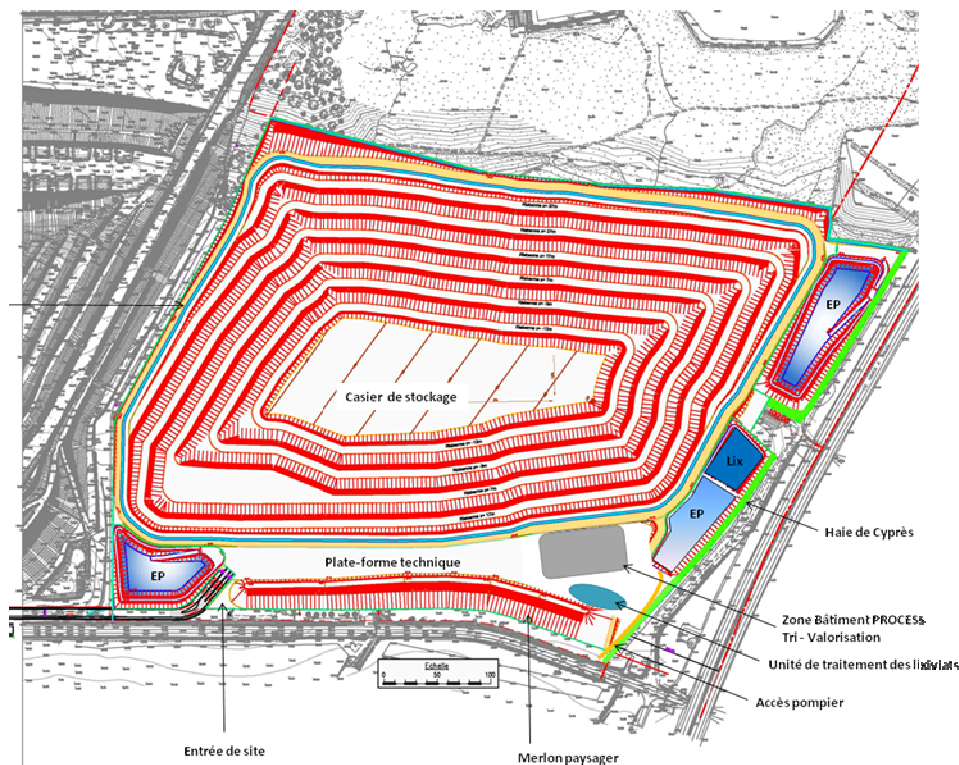
Figure 7 : Plan général des installations projetées
